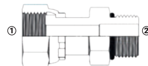
(1) Hembra Face Seal giratoria (2) Macho SAE O-ring
